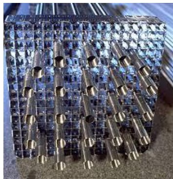
Figure 3 : vue d'une grille, déjà montée sur le squelette
