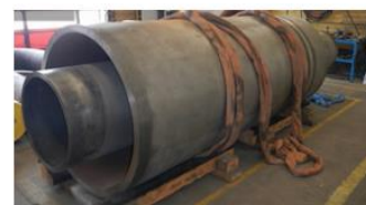
Traversée pré-fabriquée en usine
